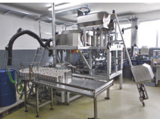
Voll automatisierte Abfüllanlage für Aerosoldosen: die eigene Abfüllung ist hier genauso an der Tagesordnung wie die Lohnabfüllung.
