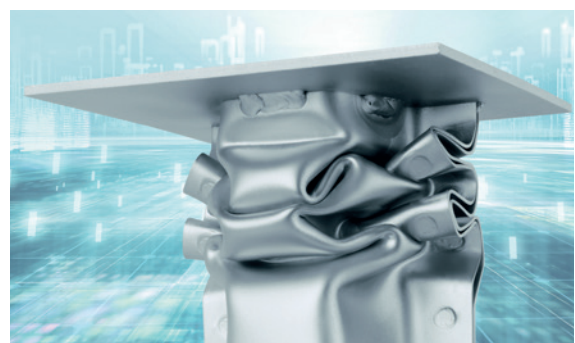
Rissfreies Faltbeulen beim Axialcrash (geschweißtes Hohlprofil, Dicke 2 mm)
