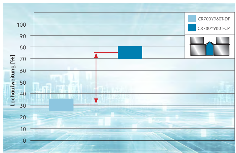
Lochaufweitungsversuch nach ISO 16630, typische Werte
