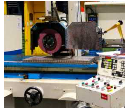
Revision an einer Flachscheifmaschine
