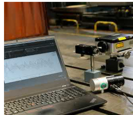
Geometrievermessung mittels Lasersystem
