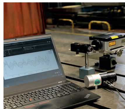
Geometrievermessung mittels Lasersystem
