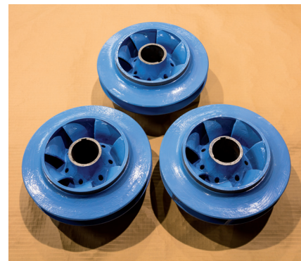
Effizienzsteigerung, beschichtete Laufräder
