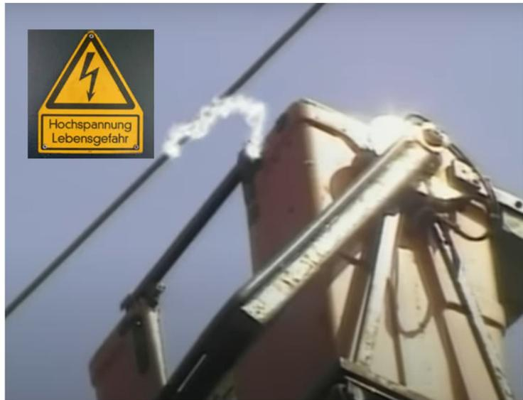
Die Ausdehnung des Spannungstrichters ist wesentlich von der Höhe der Spannung und der Beschaffenheit des Bodens abhängig. Für Mensch und Tier ist in diesem Bereich die Gefahr gegeben von „Fuß zu Fuß“ eine tödliche Spannung- Schrittspannung abzugreifen.
