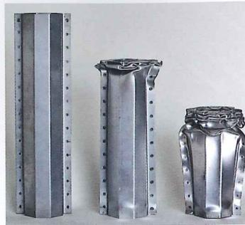
Ein kleiner Unterschied mit großen Auswirkungen: 2 verformte Crashträger (rechts aus einem Weichstahl; Mitte aus einem ahss high-ductility Stahl im Vergleich mit einem unverformten Crashträger (links). Die hohe Festigkeit in Kombination mit der sehr guten Umformbarkeit führt zu einem exzellenten Energieabsorptionsvermögen.
