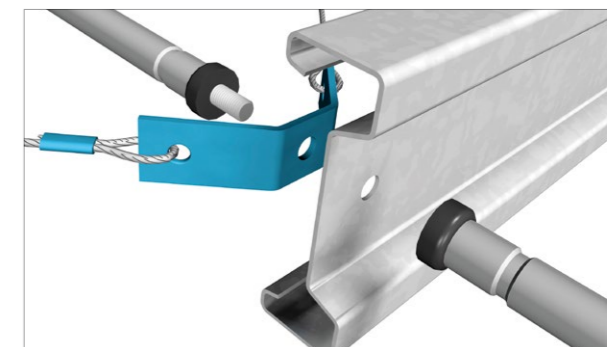
Détail de montage d'une panne avec SadeF-Lock® et bretelle double.
