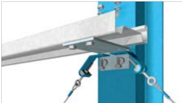
Détail de montage d'une lisse avec échantignole et bretelles.
