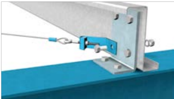
Détail de montage d'une panne avec échantignole et bretelle.
