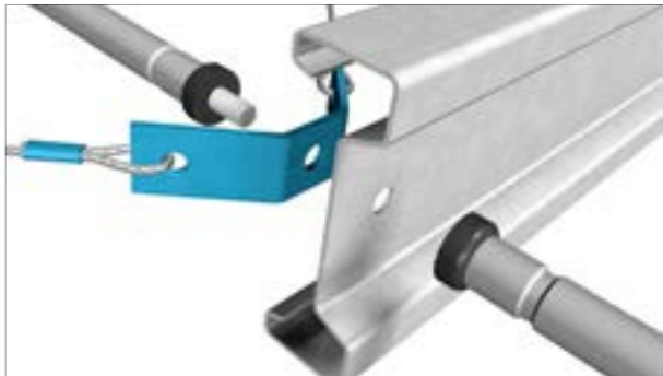
Détail de montage d'une panne avec Sadeif-Lock® et bretelle double.
