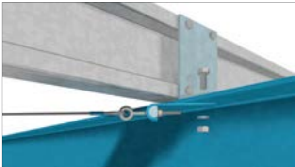
Assemblage d'une bretelle directement au portique. Utilisation des trous de fixation de l'échantignole au portique pour fixer la bretelle permettant un gain au montage sans trou supplémentaire dans le portique.*
