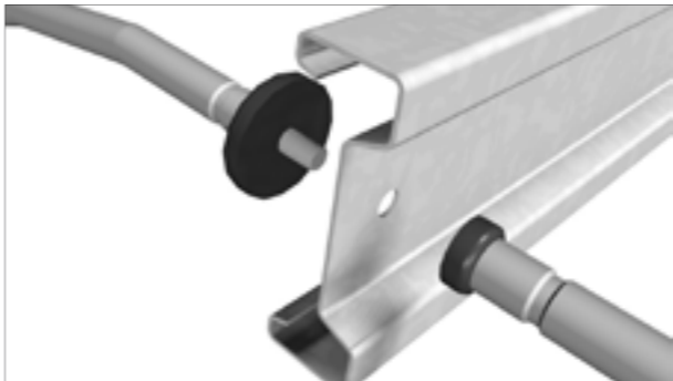
Détail de montage d'une panne + Liernes de faitage + Sadeif-Lock® lierne
