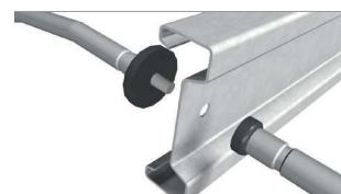
Détail de montage d'une panne + Liernes de faîtiage + Sodéf-Lock® lime
