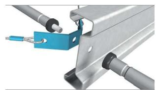
Détail de montage d'une panne avec Sodéf-Lock® et bretelle double.
