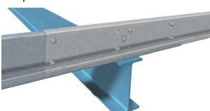
→ L'emboîtement est terminé par la mise en place des boulons restants dans les trous prévus.
