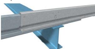
→ Fixation du deuxième profilé ZED, petite semelle vers le bas. Grâce à la perforation spéciale dans le profilé ZED, l'emboîtement peut être réalisé sans enlever le boulon central.
