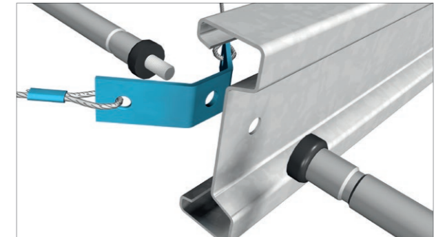
Montagedetail Dachpfette + SadeF-Lock® + doppelte Diagonalabhängung
