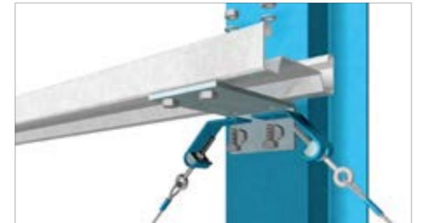
Montagedetail Wandriegel + Wandriegelhalter + Diagonalabhängung
