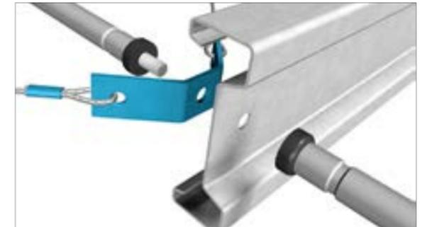
Montagedetail Dachpfette + Sadef-Lock® + doppelte Diagonalabhängung
