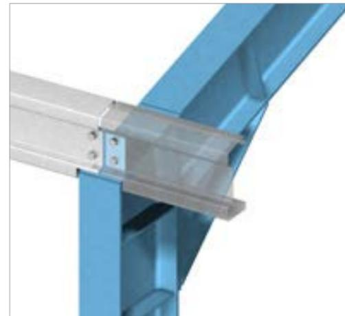
Durch sein funktionales Design können voestalpine SadeF SE-Profile bis zu Dachneigungen von 26° genutzt werden.
