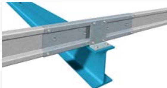
→ Wiederholung von Schritt B. Ein weiteres SIGMA-Profils + Kupplungsstück kann am Pfettenhalter befestigt werden.
