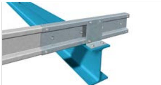
→ Befestigung des SIGMA-Profils + Kupplungsstück mit 2 Schrauben am Pfettenhalter.
