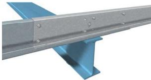
→ Die Überlappung ist fertig, wenn die Schrauben für die in den Profilen vorgesehenen Lochungen montiert sind.
