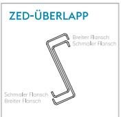
Die Flansche der ZED-Profile haben unterschiedliche Breiten. So kann durch ein Ineinanderlegen der Profile an den Auflagern eine Überlappung und somit ein Durchlaufträger realisiert werden.
