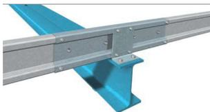
→ Wiederholung von Schritt B. Ein weiteres SIGMA-Profils + Kupplungsstück kann am Pfettenhalter befestigt werden.
