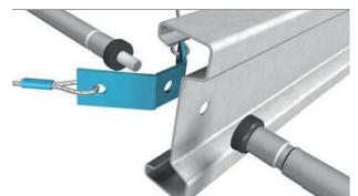
Montagedetail Dachfette + Sadef-Lock® + doppelte Diagonalabhängung
