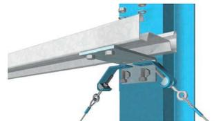
Montagedetail Wandriegel + Wandriegelhalter + Diagonalabhängung
