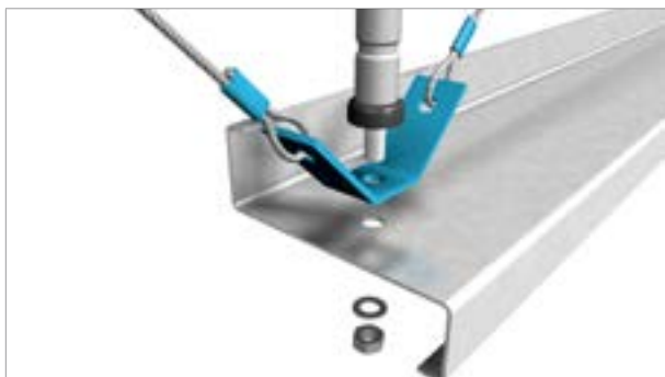
Montagedetail wandregel + Sadeef-Lock® + dubbele bretel.
