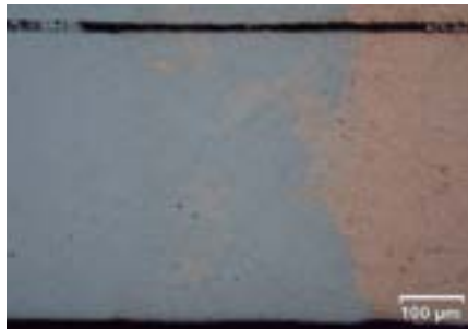
Schliffproben des metallischen Kupfer-Stahl-Verbundes
