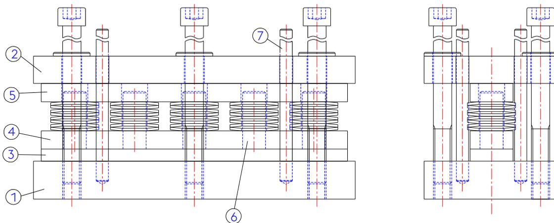
Abbildung 5: Zusammengebaute Backvorrichtung
