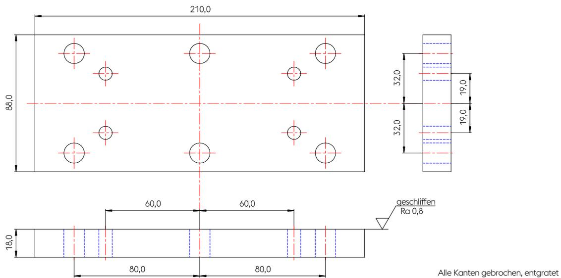
Abbildung 4: Kopfplatte der Backvorrichtung zur Herstellung der Prüfkörper
