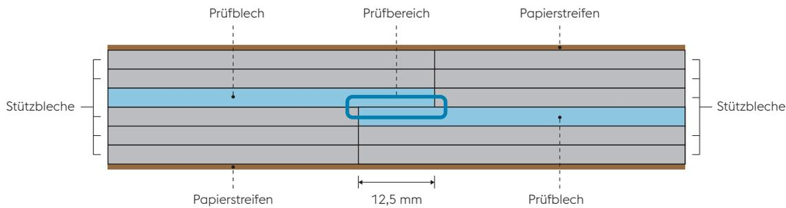
Abbildung 2: Geometrie der Prüfkörper (adaptiert von EN 1465).
