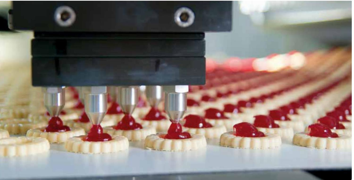
**Portionier-Einheiten** benötigen, je nach verarbeitetem Lebensmittel hohe bis höchste Korrosionsbeständigkeit und somit die Zertifizierung geprüft bei „sauren Lebensmitteln“ ( $\text{pH} < 4,5$ ), bzw. geprüft bei „wässrigen Lebensmitteln“ ( $\text{pH} > 4,5$ ).
