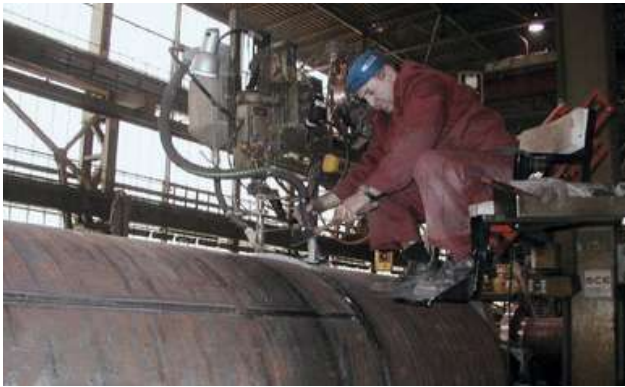
Prefabricación de la compuerta de Kaprun, Austria. Grado de acero S 690 Q, STM A514 Gr.F
