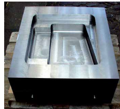
Material M200 / 1.2312 Bonificado a 950 - 1100 N/mm 2 Medida: 800 x 318 x 800 mm
