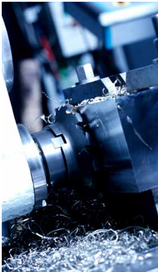
Material K600 / 1.2767 Bonificado a 50-52 HRC Medida: 346 x 35 x 396 mm
