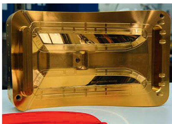
Moule revêtu de TiN-ultrafine pour le moulage par injection de matières plastiques (au 1 er plan le cache plastique fabriqué pour le secteur automobile).
