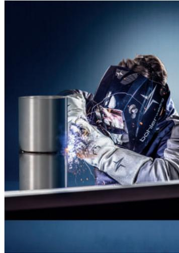
Electrodo celulósico de alta penetración para soldar aceros al carbono. Es muy usado para propósitos generales ya que tiene buena tenacidad de hasta -30°C. La fórmula especial del revestimiento produce un arco de gran fuerza de penetración.
