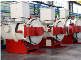
Wärmebehandlungsöfen zum Vakuumhärten
