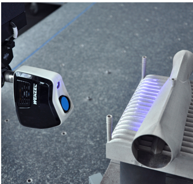
Abtastung eines AM-Bauteils mit einer Feinmessmaschine
