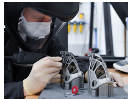
Entfernung der Stützstruktur eines Bauteils
