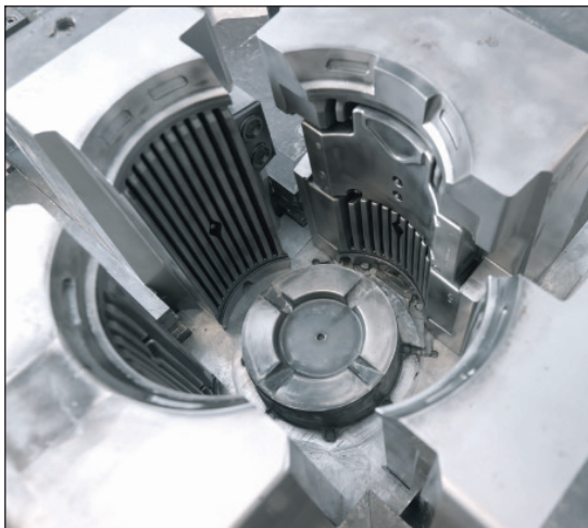
Cavidad en un molde de fundición inyectada de aluminio de alta presión.
