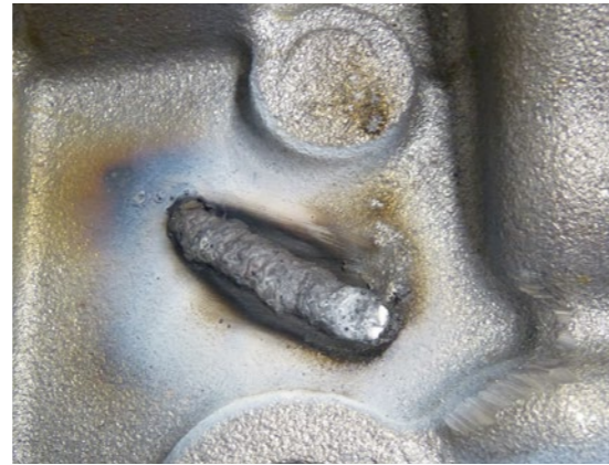
Soldadura continua corta antes de eliminar la escoria
