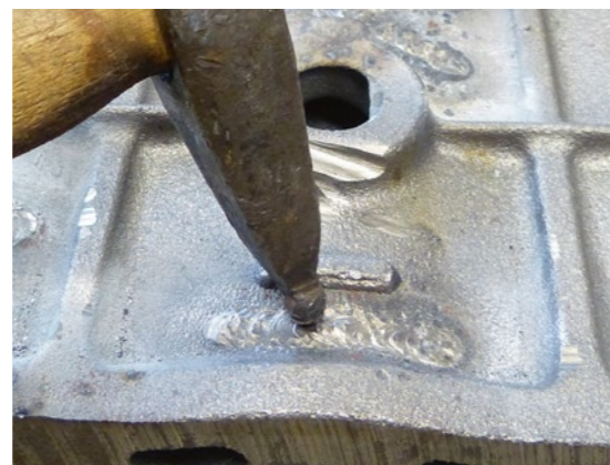
Soldadura corta después de eliminar la escoria
