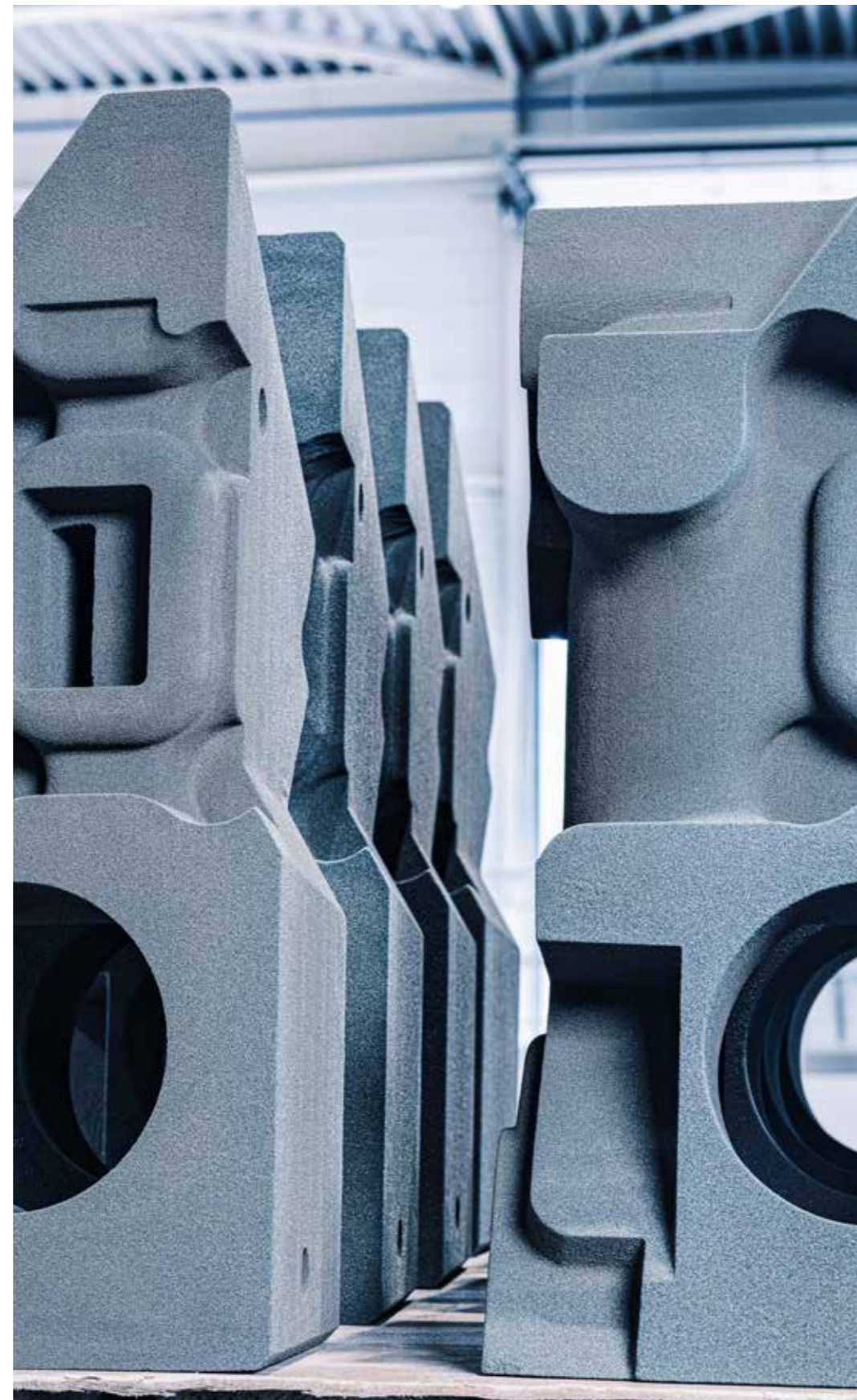
Präzise 3D-gedruckte Sandkerne für den Einsatz im Segment Bahnsysteme
