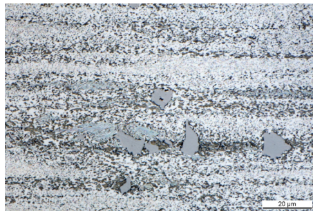
alzen® 305K-Probe, Knetlegierung, Position C, Maßstab 20µm
