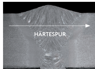
Abbildung 1: Vergleich der Aufhärtung
