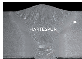
Abbildung 1: Vergleich der Aufhärtung
