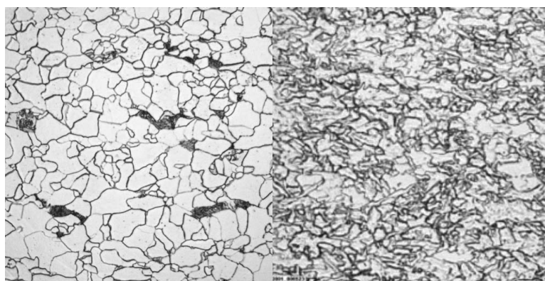
Normalisierend gewalztes Gefüge
