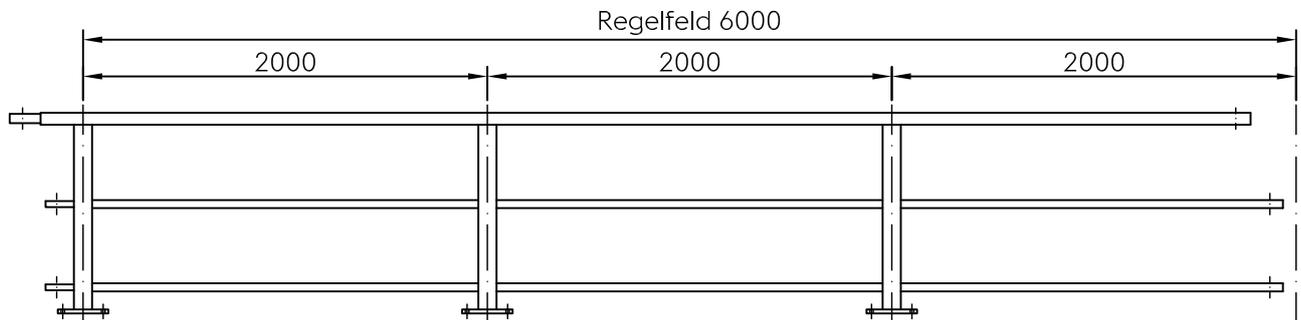
Das Regelgeländer entspricht in den Abmessungen, der Dimensionierung und der Tragfähigkeit den Anforderungen der RVS 15.04.21 - Anhang 5 (Stand 10. April 2018)
