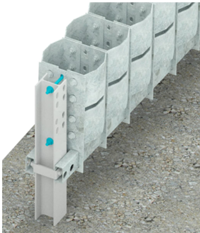
Abbildung 22: Montage der Sechskantschrauben
