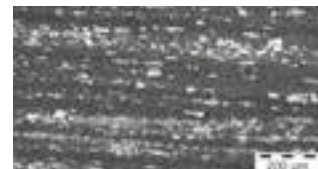
Микроструктура обычной 12% хромистой стали
