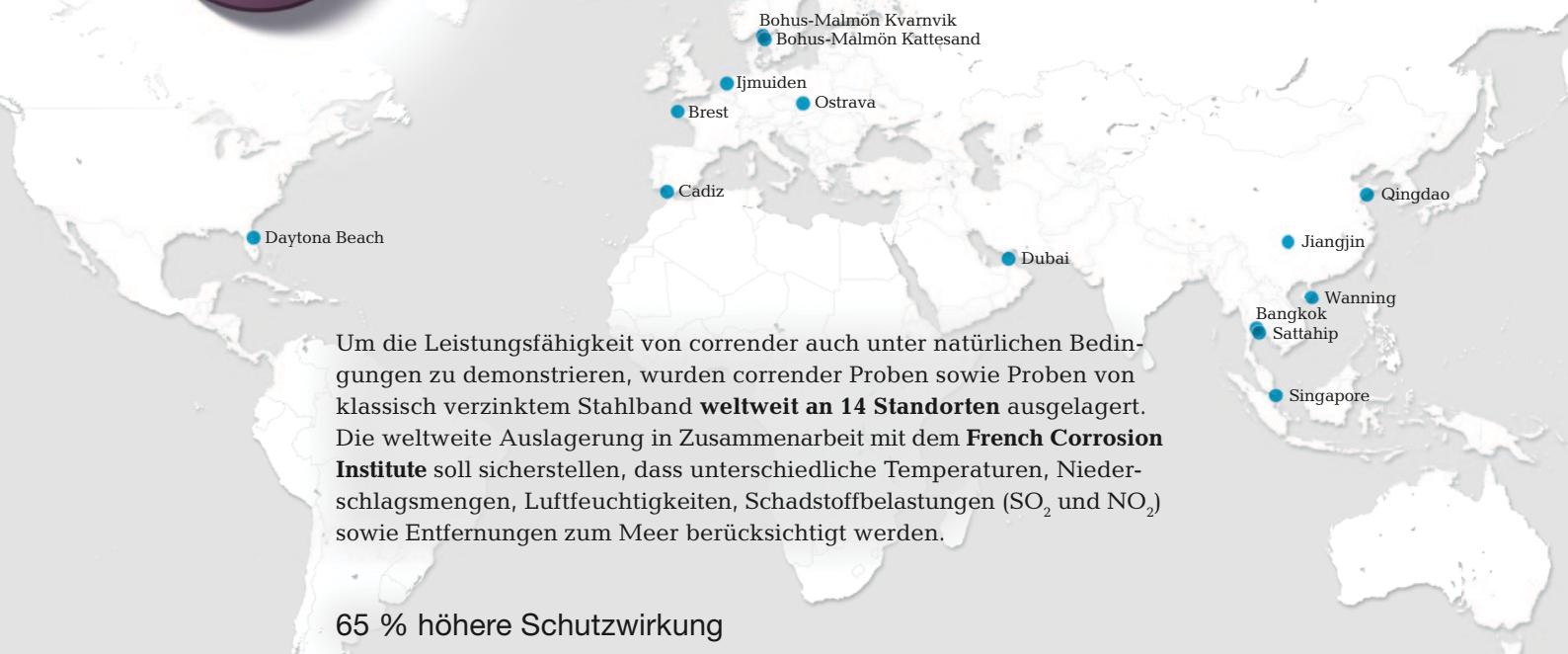
Um die Leistungsfähigkeit von corrender auch unter natürlichen Bedingungen zu demonstrieren, wurden corrender Proben sowie Proben von klassisch verzinktem Stahlband **weltweit an 14 Standorten** ausgelagert. Die weltweite Auslagerung in Zusammenarbeit mit dem **French Corrosion Institute** soll sicherstellen, dass unterschiedliche Temperaturen, Niederschlagsmengen, Luftfeuchtigkeiten, Schadstoffbelastungen ( $\text{SO}_2$  und  $\text{NO}_2$ ) sowie Entfernung zum Meer berücksichtigt werden.
