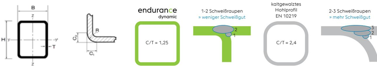
Rechenbeispiel: 100mm lange Schweißnaht, Rohrstoß, Hohlprofil 100x100x8mm
